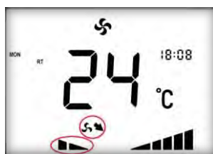
Podešavanje brzine ventilatora za ubacivanje
