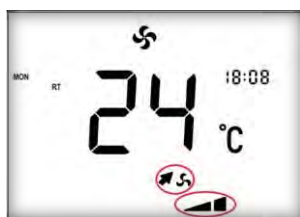
Podešavanje brzine ventilatora za izvlačenje
